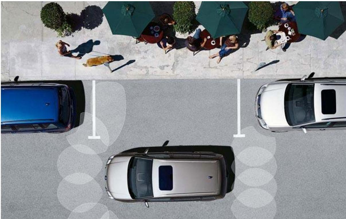
Abbildung 1: Einparkhilfe
